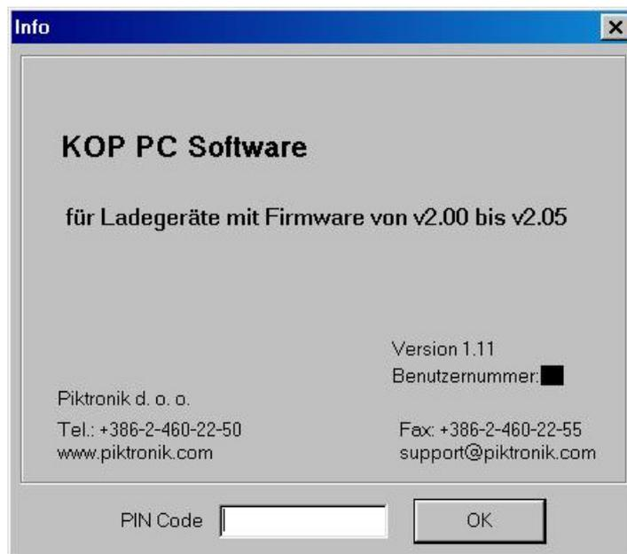
Wird kein PIN Code eingegeben, dann können die Parameter und Daten nur angeschaut oder ausgedruckt, nicht aber geändert werden.
