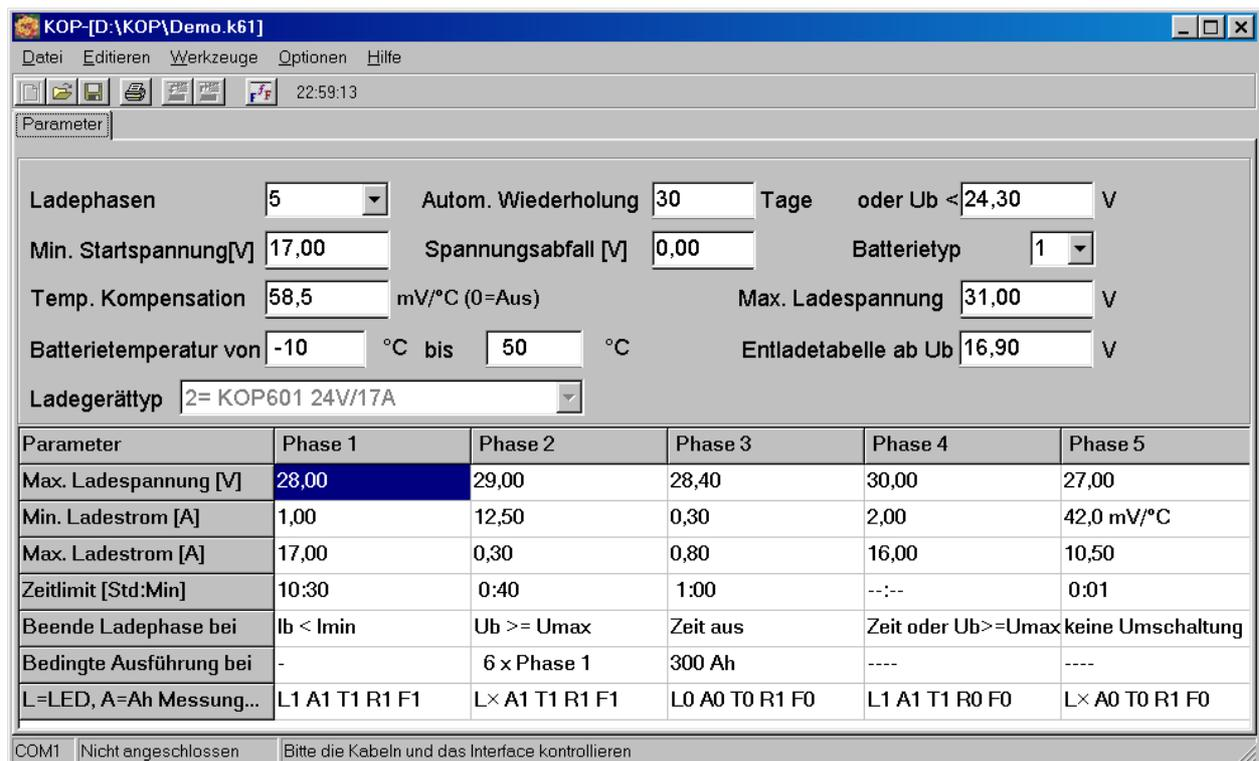
Beispiel der Ladegerätparameter. Das sind keine Parameter für einen bestimmten Batterietyp – nur Beispiel mit Darstellung einiger Möglichkeiten.
